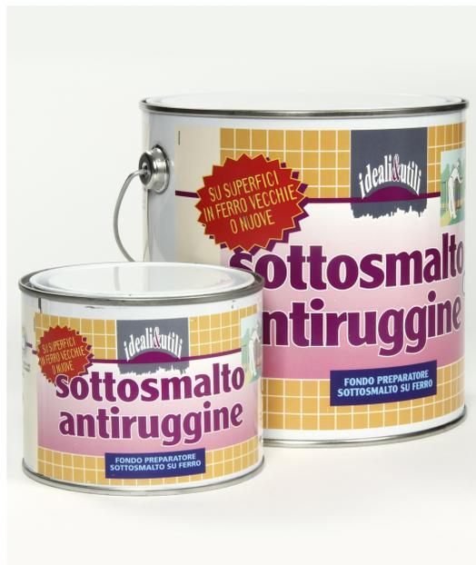
Per la protezione di manufatti in ferro soggetti alla corrosione ed alla ruggine. Si applica dopo avere accuratamente eliminato la calamina, mediante accurata pulizia manuale o per mezzo di sabbiatura. A base di resine alchidiche lungo olio, fosfato di zinco e pigmenti inorganici. Essendo costituito da prodotti – resine e pigmenti – inibitori di ruggine, crea una barriera tra la superficie del metallo e l'ambiente esterno.
